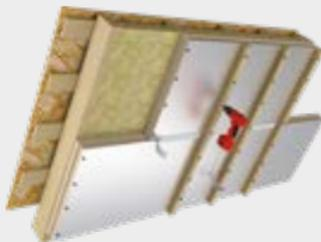
**г)** Далее осуществите финишную отделку согласно проекту. Благодаря алюминиевой фольге, которой с обеих сторон облицованы термоплиты LOGICPIR PROF Ф/Ф, возникает эффект отражения лучистого тепла внутрь помещения. Как следствие, объем теплопотерь уменьшается, возникает возможность экономии энергоресурсов.
