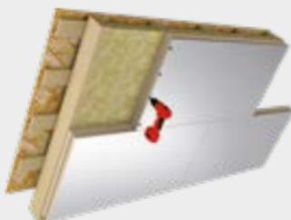
**б)** Для создания полностью паронепроницаемого барьера проклейте стыки термоплит алюминиевой самоклеящейся лентой. Применение LOGICPIR PROF Ф/Ф позволяет полностью отказаться от монтажа пароизоляционной пленки – фольга, служащая обкладкой термоплит, препятствует проникновению увлажненного воздуха внутрь конструкции и дальнейшей конденсации влаги.
