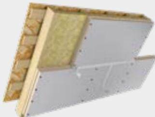
**в)** Основной крепеж термоплит LOGICPIR PROF Ф/Ф осуществляется через деревянные бруски. Шаг брусков должен быть равен шагу стропильных ног.
