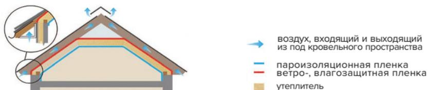
Рис. 1. Устройство вентиляции мансарды
