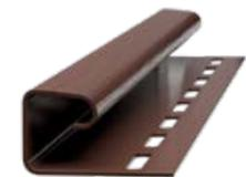
Предназначен для оформления нижнего торца плит ОСП-3 под стартовой полосой фасадной плитки, уложенной на фасад, в случае использования заглубленного цоколя под основным фасадом. Защищает основание от капиллярного водопоглощения.
