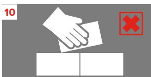
После укладки запрещается отрывать блок от поверхности, в случае отрыва блока от поверхности необходимо нанести клей-пену повторно.
