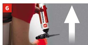
Рабочее положение баллона при производстве работ — дном вверх.
