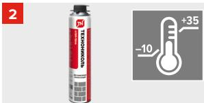
Клей -пена применяется при температуре от  $-10$  до  $+35$  °C. Перед началом работ баллон необходимо выдержать при комнатной температуре ( $18$ – $20$  °C) в течение 10 ч.
