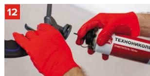
После завершения работ необходимо тщательно промыть пистолет с помощью очистителя монтажной пены.
