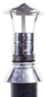
Установите юбку из оцинкованной стали на трубу и наживите обжимным хомутом. между трубой и юбкой нанесите Мاستику герметизирующую ТЕХНОНИКОЛЬ № 71 и плотно затяните обжимной хомут. Юбка должна перекрывать стакан на 75 мм по высоте.
