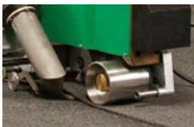
Прикаточный ролик должен быть размещен от кромки материала на 5 мм.
