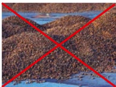
**ВАЖНО!** Не допускается заполнение пустот гофр насыпным утеплителем.
