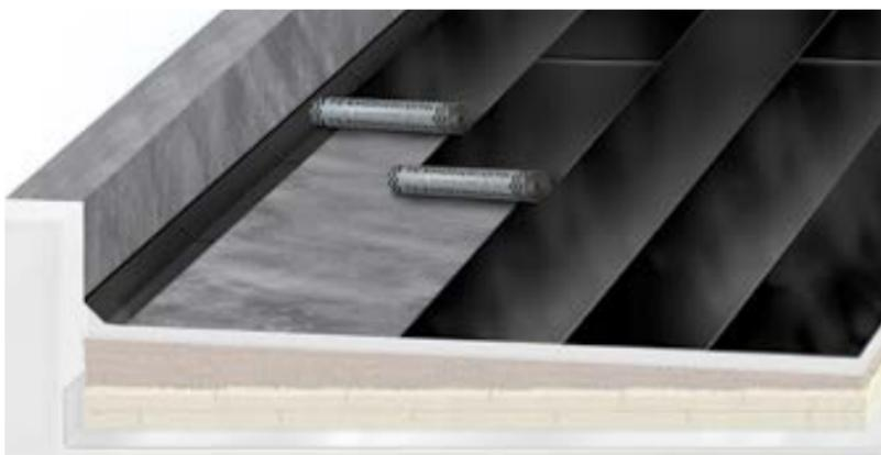
Торцевую часть рулона можно завести на наклонный бортик без устройства слоя усиления. Это возможно только при подведении рулона к вертикальной конструкции торцевой частью: на вертикальную поверхность торцевая часть рулона должна заходить на 25 мм выше от наклонного бортика.
