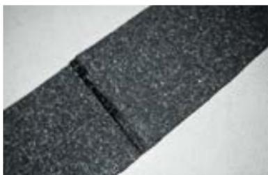
После полного остывания сварного шва вырежьте из пробного сваренного участка полосу шириной в 50 мм и проверьте качество склейки и ширину сварного шва (не менее 90 мм).
