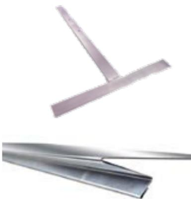
Т-образный кровельный костыль — предназначен для крепления оцинкованных отливов и фартуков на парапеты. Костыль должен быть толщиной не менее 4 мм и покрыт антикоррозионными составами.
