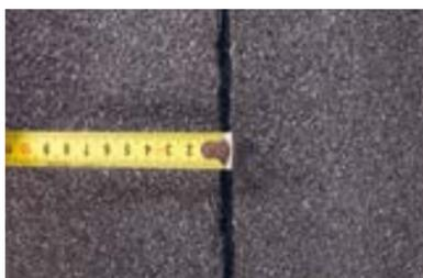
Признаком хорошего, правильного прогрева материала является вытекание битумно-полимерного вяжущего из-под боковой кромки материала от 10 мм до 25 мм.
