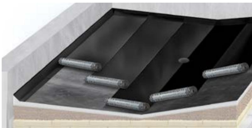
**ВАЖНО!** Самый первый уложенный рулон на пониженном участке водоприемной воронки должен быть перекрыт с каждой стороны соседними полотнищами на 100 мм.
