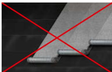
**ВАЖНО!** Перекрестная наклейка полотнищ рулонов верхнего и нижнего слоев основного кровельного ковра не допускается!
