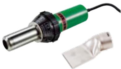
**Ручной фен горячего воздуха типа Ляйстер Электрон ST (Leister Electron ST) с щелевой насадкой 75 мм** для сварки нахлестов полотнищ битумно-полимерных материалов (Техноэласт Фикс и Техноэласт СОЛО РП1).
