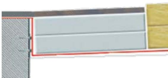
В случае устройства каркаса жесткости приступайте к его монтажу после устройства пароизоляционного слоя (см. п. 2.2);
