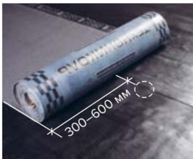
Расстояние между боковыми стыками кровельных полотнищ в смежных слоях должно быть 300–600 мм. Для удобства сместите верхний рулон на половину ширины, т.е. на 500 мм.
