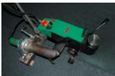
Подъемным устройством поднимите прикаточный ролик.
