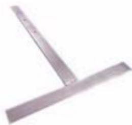
Т-образный кровельный костыль — предназначен для крепления оцинкованных отливов и фартуков на парапеты. Костыль должен быть толщиной не менее 4 мм и покрыт антикоррозионными составами.
