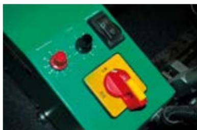
Сначала выставьте параметры (температуру воздуха (550–600 °С) и скорость движения) сварочного аппарата.
