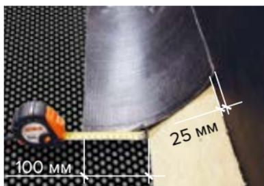
Наплавьте полосы слоя усиления из материала в соответствии с п. 5.1.1.
