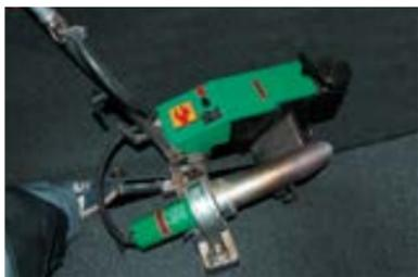
Для удобства заведения насадки под шов отогните боковую кромку уложенного сверху материала и поставьте ногу на боковую кромку механически зафиксированного материала.
