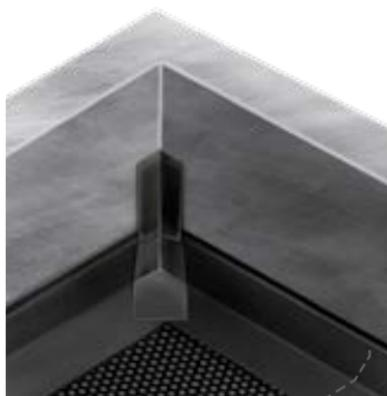
Наплавьте заплатку на угол для герметизации шва. Заплатку заведите на высоту дополнительного нижнего слоя (не менее 250 мм).
