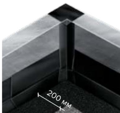
Для качественного наплавления на материал с крупнозернистой посыпкой, удалите посыпку из зоны сварки.
