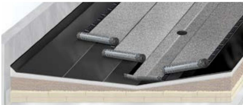
Соблюдайте порядок раскладки материала в боковых нахлестах от самых низких точек кровли к самой высокой для предотвращения противотока. Вода должна стекать со шва в сторону водораздела.
