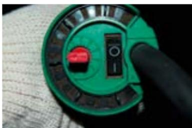
С помощью регулировки установите необходимую температуру воздуха на выходе из сопла. Для сварки выберите рабочую температуру 550–600 °С в зависимости от погодных условий и индивидуальной скорости сварки.
