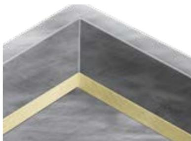
Установите наклонные бортики (ТЕХНОРУФ ГАЛТЕЛЬ) на Мasticку кровельную горячую ТЕХНОНИКОЛЬ № 41 (Эврика) в местах примыкания с парапетом.
