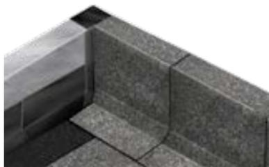
Наплавьте дополнительный верхний слой на всю плоскость парапета с одной стороны угла парапета.
