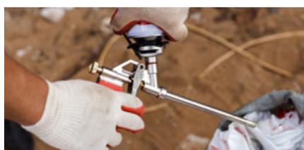
**10.** Удалите незастывший клей и очистите пистолет после использования при помощи очистителя монтажной пены ТЕХНОНИКОЛЬ.
