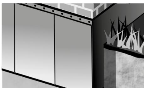
Верхний край гидроизоляционного материала необходимо закрепить в цокольной части профилированной металлической краевой рейкой. Верхнюю часть рейки загидроизолировать полиуретановым герметиком.
