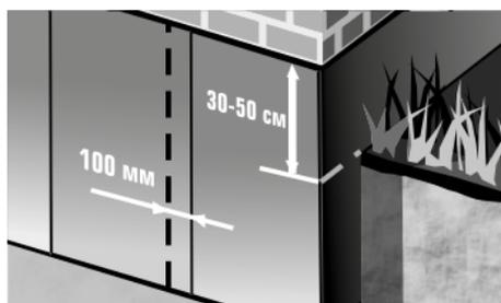
Материал заводится выше уровня земли на 30-50 см. Размер продольного нахлеста составляет 100 мм, размер поперечного нахлеста – 150 мм.
