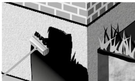
Очистить и загрунтовать поверхность битумным праймером. Монтаж материала начинать после полного высыхания битумного праймера.
