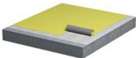
1. Монтаж первого слоя гидроизоляции.
