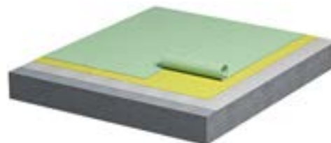
2. Монтаж второго слоя гидроизоляции.
