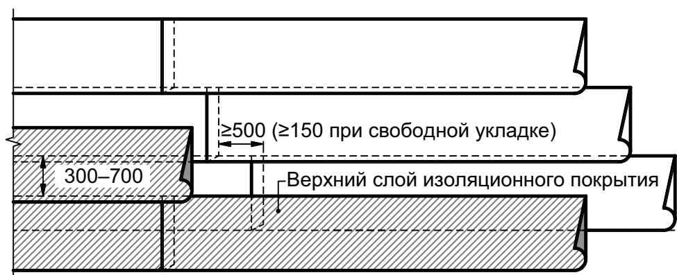
Рисунок Д.2 — Смещение полотнищ гидроизоляционных материалов в смежных слоях
